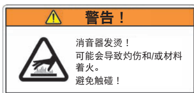
部件号 542 16 90-65 位置：皮带防护罩顶部
