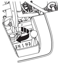
Eine ab Werk mit einem 3-Ganggetriebe ausgestattete Maschine erfordert bei einem Wechsel der Klingengröße konstruktionsbedingt nur minimale Anpassungen. Trotzdem sind einige Anpassungen notwendig. Die Maschine ist ab Werk so konfiguriert, dass sie mit einer festgelegten Anzahl an Klingengrößen, die sich in dem werkseitig installierten Klingenschutz befinden, verwendet werden kann.
