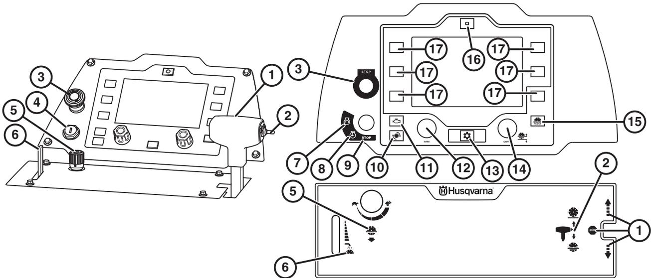
Die Bedientafel ist die Verbindung des Bedieners zum Gerät. Von hier aus kann der Bediener alles kontrollieren, wie die Drehzahl des Motors und die Schnitttiefe der Klinge, sowie den aktuellen Status des Motors und der Maschine ablesen.
