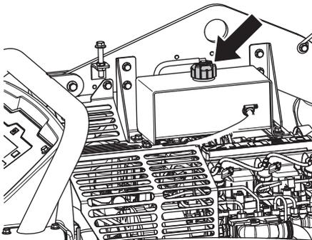
Der Pegel der Kühlerflüssigkeit sollte den Beginn des Schlauchs im Inneren erreichen.
