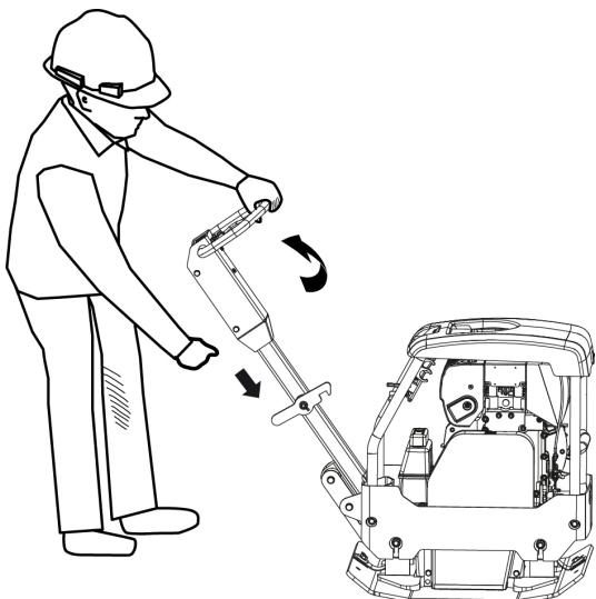
**ΕΙΔΟΠΟΙΗΣΗ** Στη διάρκεια των εργασιών πάκτωσης, απαιτείται λειτουργία του κινητήρα σε πλήρη ισχύ.
