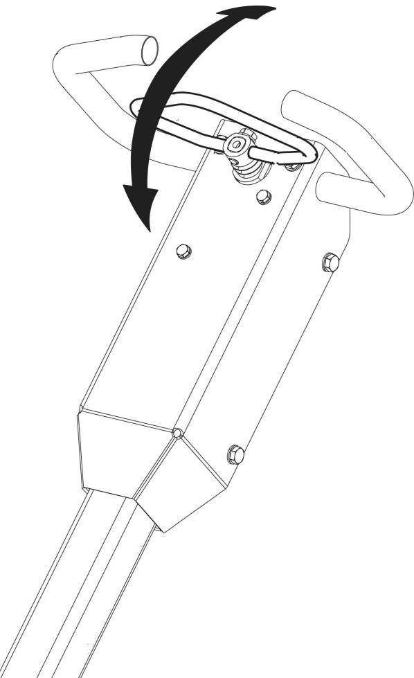
**ΕΙΔΟΠΟΙΗΣΗ** Η κατεύθυνση και η ταχύτητα οδήγησης μπορούν να μεταβληθούν με συνεχή τρόπο με τη βοήθεια του υδραυλικού μοχλού.
