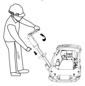
AVVISO Durante il lavoro di compattamento il motore deve sempre funzionare con farfalla interamente aperta.
