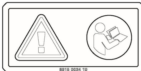
Manuale di istruzioni. L'operatore deve leggere le istruzioni per la sicurezza, il funzionamento e la manutenzione prima di lavorare con la macchina.
