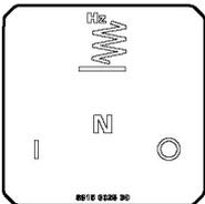
Para controlo do acelerador EPA (Agência de Protecção Ambiental dos EUA) com três posições fixas.
