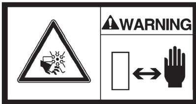
Componenti del motore rotanti. Tenere le mani ad una distanza di sicurezza dalla zona pericolosa.
