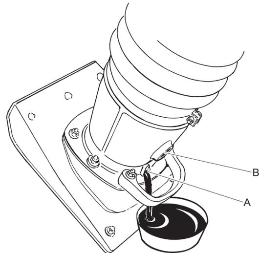
1. Lösen Sie die Ölablassschraube (A).
