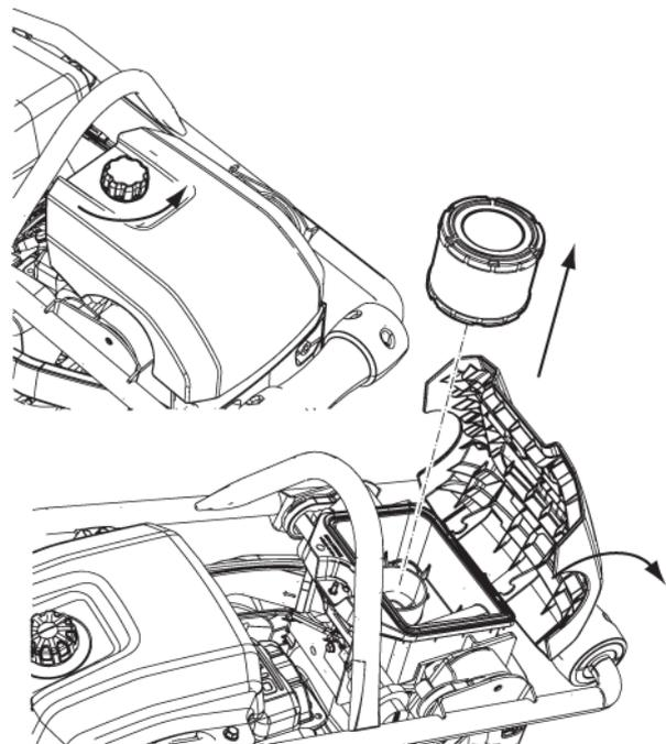
Prüfen und reinigen Sie den Luftfilter (A).
