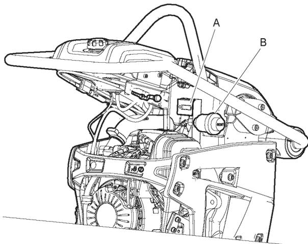
Prüfen Sie die Luftfilteranzeige (A). Ersetzen Sie den Luftfilter, wenn die Anzeige den roten Bereich erreicht.
