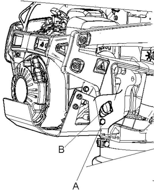
1. Lösen Sie die Ölablassschraube (A).
