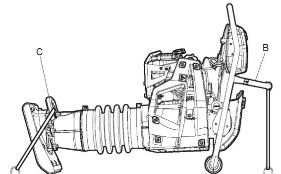
4. Beim Transport über kurze Distanzen kann die Maschine nach vorne gekippt werden, sodass sie auf den Kunststoffrädern am Griff liegt. Heben Sie die Maschine am unteren Griff (D) an, und rollen Sie sie vor und zurück.
