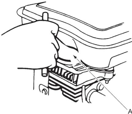
Prüfen und reinigen bzw. ersetzen Sie ggf. Sie die Zündkerze (A).
