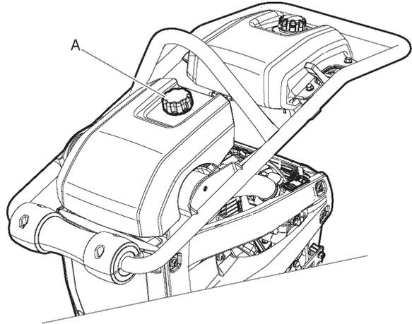
Stellen Sie sicher, dass der Haubenschluss (A) in einem guten Zustand ist.
