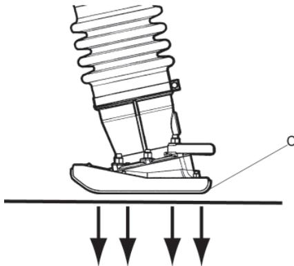
4. Überlasten Sie bzw. drücken Sie nicht auf die Maschine.
