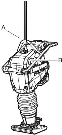
2. Das Hebezeug muss richtig dimensioniert sein, damit die entsprechenden Vorschriften eingehalten werden. Stellen Sie vor dem Anheben sicher, dass die Gummielemente (B) und die Hebeöse (A) korrekt angebracht und nicht beschädigt sind.
