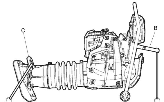
4. Ao movimentar distâncias curtas, a máquina pode ser inclinada para a frente, para que assente sobre as rodas plásticas na pega. Levante com a pega de elevação inferior (D) e rode a máquina para a frente e para trás.
