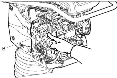
3. Feche o comando do ar (C) se o motor estiver frio; se o motor estiver quente ou se a temperatura ambiente for alta, empurre o comando do ar metade para dentro, ou deixe-o aberto.
