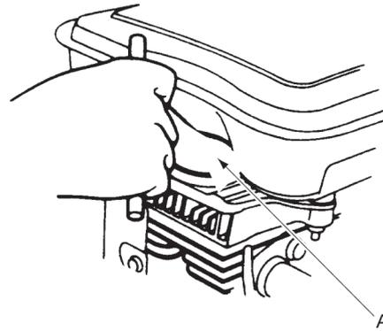
Verifique e limpe a vela de ignição (A), e substitua-a se necessário.
