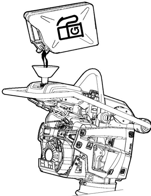
3. Desaperte a tampa do depósito lentamente, para deixar sair a pressão do depósito.
