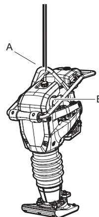
2. Il dispositivo di sollevamento deve essere dimensionato per conformarsi a tutte le normative vigenti. Prima di effettuare il sollevamento controllare che i componenti in gomma (B) e l'occhiello di sollevamento (A) siano attaccati correttamente e non danneggiati.
