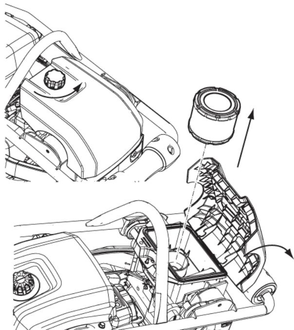
Controllare e pulire il filtro dell'aria (A).
