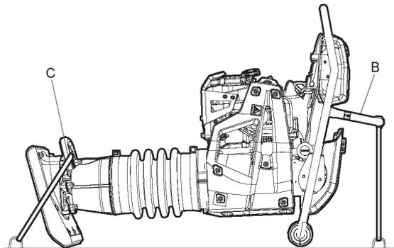
4. Per eseguire brevi spostamenti, la macchina può essere inclinata in avanti in modo che poggi sulle ruote di plastica dell'impugnatura. Sollevare tramite la maniglia di sollevamento inferiore (D) e far oscillare la macchina avanti e indietro.
