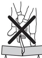
チェンがキックバックゾーンで挟まったり、引っかかたりすると、反作用力により、作業者に向かってパワーカッターが回転しながら飛ばされて、人命にかかわるような事故が発生することもあります。作業対象物が動く可能性があるため、注意してください。切断面が閉じて、カッティング装置が挟まれることがあります。
