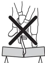
Se a corrente for comprimida ou ficar presa na zona de retrocesso, a força reativa pressionará o cortador de disco para cima e para trás na direção do usuário em um movimento de rotação, causando ferimentos graves ou mesmo fatais. Esteja alerta para movimento potencial da peça de trabalho. Fique alerta ao movimento da peça de trabalho ou a qualquer outro evento que faça com que o corte feche e comprima o equipamento de corte.
