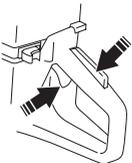
**注意！**用右手将启动器拉绳慢慢拉出，直至感觉到阻力（由于启动器棘爪啮合），然后用力快速拉动。不要将启动器的拉绳拉到底，也不要完全拉出的位置放开启动器把手。这样做会损坏机器。
