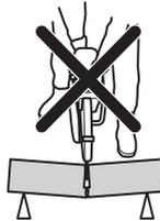
如果锯片在反冲区被夹住或者受阻，反作用力会将电动切割锯向上向后抛起，飞向使用者，造成严重甚至致命性伤害。要警惕工件可能的移动。如果工件未妥善支撑并在切割时发生移位，可能会夹住锯片，导致反冲。
