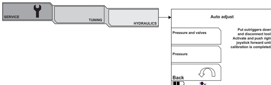
Pour le réglage automatique, la machine doit se trouver sur les stabilisateurs et l'outil doit être débranché.
