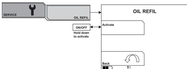
La jauge indique le niveau d'huile en pourcentage, au dixième près. Maintenez la touche de sélection enfoncée pour effectuer le remplissage d'huile. La pompe s'arrêtera automatiquement lorsque le réservoir est plein.
