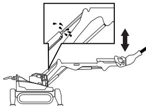
Le cylindre 3 se trouve dans sa position extérieure et le marteau travaille vers le bas. Ne jamais utiliser les cylindres dans leurs positions finales.
