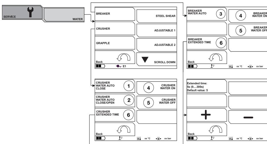
Le DXR équipé d'une trousse de réduction de poussière active la fonction d'eau. On peut activer la fonction au moyen de divers outils.
