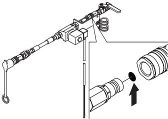
Inspecter tous les jours le **filtre à tamis** du dispositif de raccordement à embout, nettoyer au besoin.
