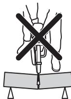
Se il disco è schiacciato o bloccato nel settore di contraccolpo, la forza di reazione respingerà la troncatrice in senso rotatorio in alto e indietro verso l'utente causando lesioni gravi o mortali. Fare attenzione al possibile spostamento del pezzo in lavorazione. Se esso non è adeguatamente supportato e si sposta durante il taglio, potrebbe schiacciare la lama e causare un contraccolpo.
