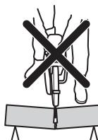
Wird die Klinge eingeklemmt oder bleibt sie im Rückschlagbereich stecken, kann die Heftigkeit der Rückschlageffekte zu heftigen Drehbewegungen und starkem Wackeln des Trennschleifers führen, was schwere oder tödliche Verletzungen verursachen kann. Auf mögliche Bewegungen des Werkstücks achten. Wenn das Werkstück nicht ausreichend gestützt ist und sich beim Schneiden verschiebt, kann es durch Einklemmen der Trennscheibe zu einem Rückschlag kommen.
