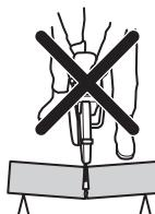
Ako se nož zaglavi ili zaustavi u zoni povratnog trzaja, motorni čistač će se usled reaktivne sile odbaciti i okreći unazad prema korisniku što dovodi do ozbiljnih ili čak fatalnih povreda. Pazite na moguće pokrete komada koji obradujete. Ako komad koji obradujete nije pravilno pričvršćen i pomeri se tokom sečenja, on može uštinuti sečivo i izazvati povratni trzaj.
