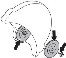
Χρησιμοποιείτε μόνο ροδέλες της Husqvarna με ελάχιστη διάμετρο 105 mm/4,1".
