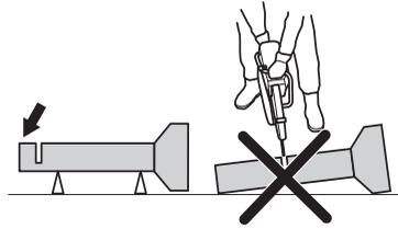
Pokud se trubka může prohnout a uzavřít řez, dojde k sevření kotouče v zóně zpětného rázu, což může vyvolat silný zpětný ráz. Pokud je trubka řádně podepřena a konec trubky se pohne směrem dolů, řez se otevře a nedojde k přiskřípnutí.
