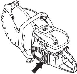
**UPOZORNĚNÍ!** Znečištěný nebo ucpaný řívod vzduchu má za následek přehřívání zařízení, což vede k poškození válece a pístu.
