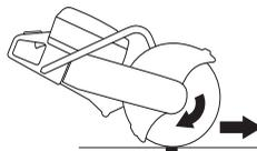
Se strojem nikdy nepochybujte, je-li řezné zařízení v pohybu. Zamýšlenému pohybu mohou bránit gyroskopické síly.
