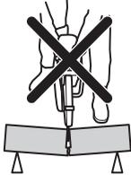
Pokud dojde k zaseknutí kotouče v zóně zpětného rázu, reaktivní síla rozbrušovací pilu vymrští směrem nahoru a zpět k uživateli rotačním pohybem způsobujícím vážné nebo dokonce smrtelné zranění. Mějte se na pozoru před možným pohybem zpracovávaného dílu. Pokud není zpracovávaný díl řádně podepřen a při řezání se posouvá, může přiskřípnout kotouč a způsobit zpětný ráz.
