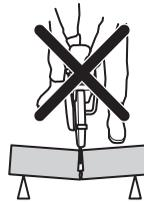
Jeżeli tarcza zaciśnie się lub zaklinuje w strefie odbicia, siła reakcji pchnie przecinakarkę do góry i do tyłu w stronę użytkownika w ruchu obrotowym, powodując poważne lub nawet śmiertelne obrażenia. Uważnie obserwuj potencjalne ruchy ciętego materiału. Jeśli materiał cięty nie został prawidłowo podparty i przesuwają się podczas cięcia, może nastąpić zaciśnięcie tarczy i odbicie.
