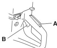
Poistka páčky zostane stlačená, pokiaľ bude stlačený plyn. Keď povolíte stisk držiadla, páčka plynu aj poistka páčky plynu sa vrátia do svojej pôvodnej polohy. Je to riadené dvomi nezávislými vratnými pružinovými systémami. To znamená, že páčka plynu sa automaticky zablokuje v polohe voľnobehu.
