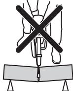
Ak sa kotúč zasekol alebo uviazol v zóne spätného nárazu, reakčná sila rotačným pohybom vyhodí rozbrusovaciu pílu dozadu smerom na používateľa a môže spôsobiť vážne alebo dokonca smrteľné zranenie. Dávajte pozor na potenciálny pohyb obrobku. Ak obrobok nie je pevne podopretý a pri rezaní sa posunie, mohol by zovrieť kotúč a spôsobiť spätný náraz.
