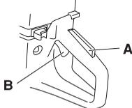
Blokada wyłącznika pozostaje wciśnięta dopóty, dopóki wciśnięty jest wyłącznik. Z chwilą puszczenia uchwytu zarówno dźwignia gazu, jak i przycisk blokady powracają do swojego pierwotnego położenia. Odbywa się to za pomocą dwóch niezależnie od siebie działających sprężyn powrotnych. Oznacza to, że dźwignia gazu zostaje automatycznie zabezpieczona w położeniu biegu jałowego.
