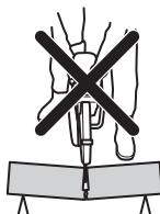
Ako se nož zaglavili ili zaustavi u zoni povratnog trzaja, motorni čistač će se usled reaktivne sile odbaciti i okrenuti unazad prema korisniku što dovodi do ozbiljnih ili čak fatalnih povreda. Pazite na moguće pokrete komada koji obradujete. Ako komad koji obrađujete nije pravilno pričvršćen i pomeri se tokom sečenja, on može uštinuti sečivo i izazvati povratni trzaj.
