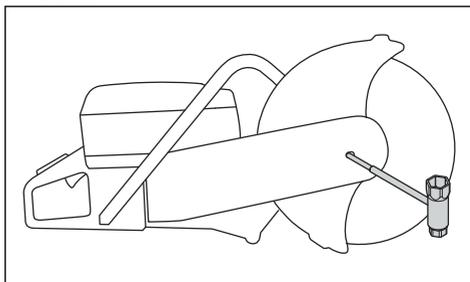
2. 2本のボルト (A) と調整ネジ (B) を緩めて、ベルトの張力を緩めます。
