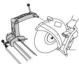
**注意：**也可以在安装产品时，使左侧紧靠在钢轨夹持器上，但我们建议尽可能使用右侧。
