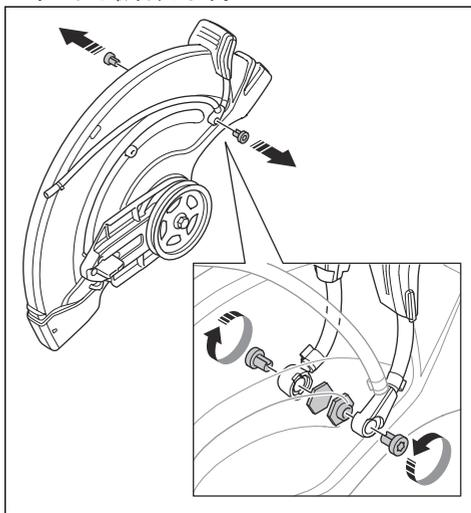
3. ブレードガードの調整ハンドルから2本のネジを取り外します。
