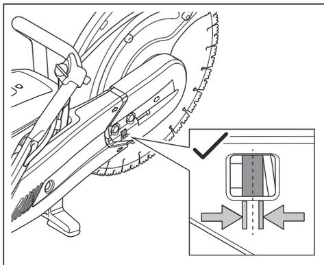
1. 拧松将切割头固定到切割臂上的 2 颗螺栓。
