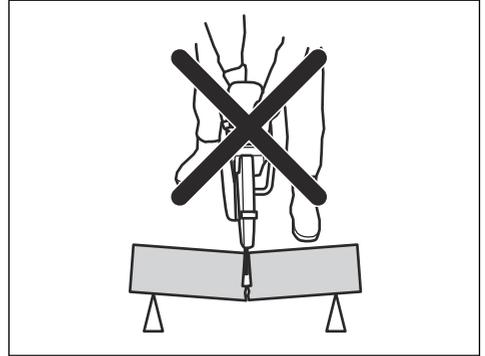
如果锯片在反弹区被夹住或停转，反作用力会将切割锯向上向后抛起，飞向使用者，造成严重甚至致命性伤害。要警惕工件可能的移动。如果工件未妥善支撑并在切割时发生移位，可能会夹住锯片，导致反弹。
