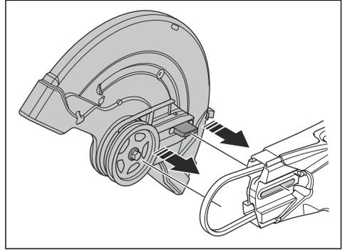
8. カuttingヘッドとドライブベルトカバーを取り付けます。駆動ベルトを交換するには66ページを参照してください。
