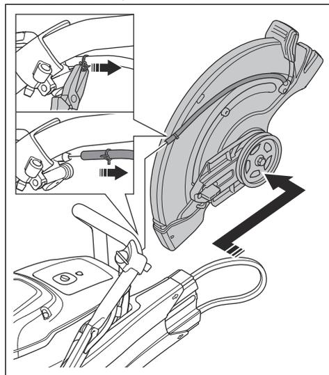
6. リヤベルトガードのナットを取り外し、リヤベルトガードを取り外します。
