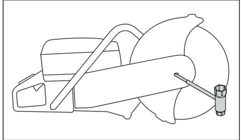
4. اربط مسمار شفرة القطع بقوة 30 نانومتر/18.5 قدم-رتال.
