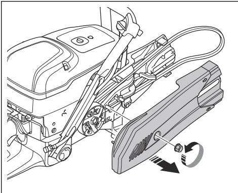
5. 从皮带轮上拆下驱动皮带，然后拆下切割头。
