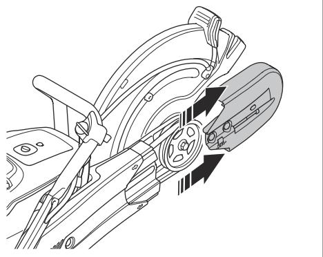
6. 拆下后皮带保护罩上的螺母，然后拆下后皮带保护罩。
