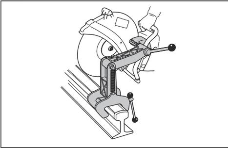
d) 将切割锯片紧靠在钢轨上，并确保其位于切口中心。如有必要，调整夹持器安装衬套。
