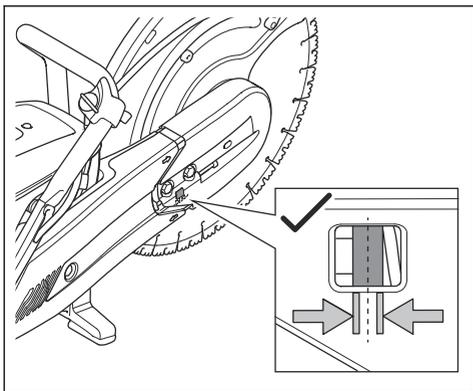
1. カッティングヘッドをカッティングアームに固定している 2 本のボルトを緩めます。
