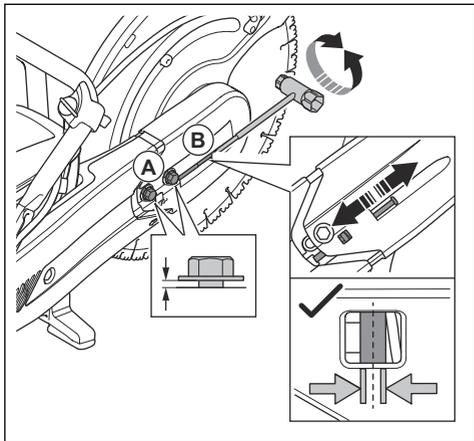
3. 使用组合扳手，拧紧将切割头固定到切割臂上的 2 颗螺栓。
