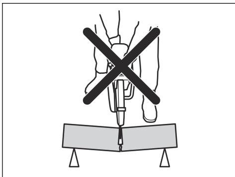
ブレードのキックバックゾーンが挟まったり、引っかかったりすると、反作用力により、作業者に向かってパワーカッターが回転しながら飛ばされて、人命にかかるような事故が発生することがあります。作業対象物が動く可能性があるので、注意してください。作業対象物がしっかりと保持されておらず、切断時に動くと、ブレードが挟まり、キックバックの原因になる可能性があります。
