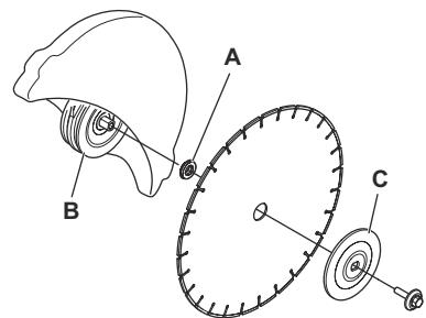
3. 工具をカッティングヘッドの穴へ入れ、シャフトがロックされるまでカッティングブレードを回転させます。
