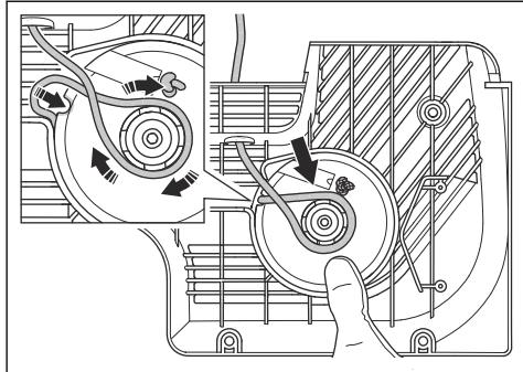
5. 让启动器滑轮缓慢旋转，启动绳缠绕在金属套筒上。
