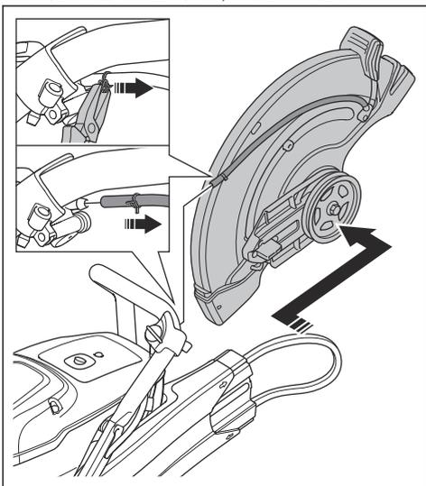
6. 拆下后皮带保护罩上的螺母，然后拆下后皮带保护罩。
