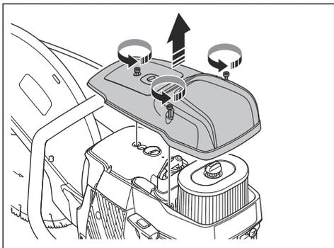
2. 感電の危険を回避するために、スパークプラグキャップやイグニッションケーブルが損傷していないことを確認してください。
