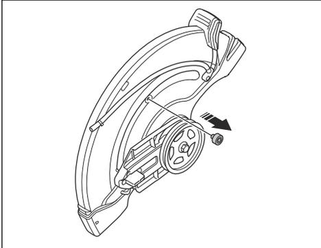
5. ベアリングハウジングを動かし、ストップスリーブを取り付けます。
