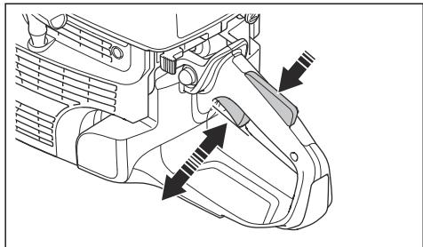
1. 按下减压阀以降低气缸中的压力。当产品启动后，减压阀会返回至初始位置。
