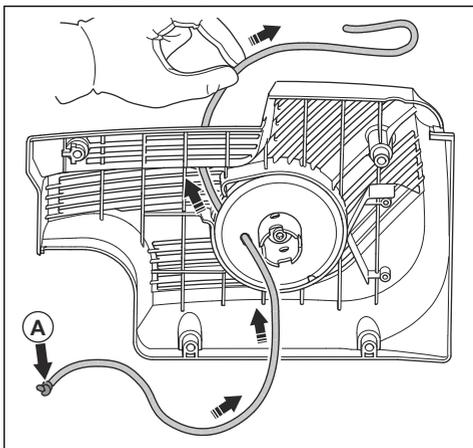
13. スターターロープハンドルを通してスターターロープを引き出し、スターターロープ (A) の末端で結び目を作ります。
