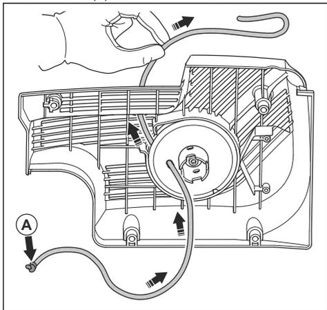
13. 拉动启动绳穿过启动绳把手，并在启动绳 (A) 的末端打一个结。
