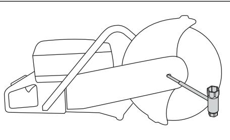
4. カッティングブレードボルトを  $30 \text{ Nm} / 18.5 \text{ ft-lb}$  で締め込みます。
