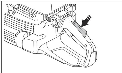
3. スロットルトリガーとスロットルトリガーロックがスムーズに動き、リターンスプリングが正しく機能することを確認します。
