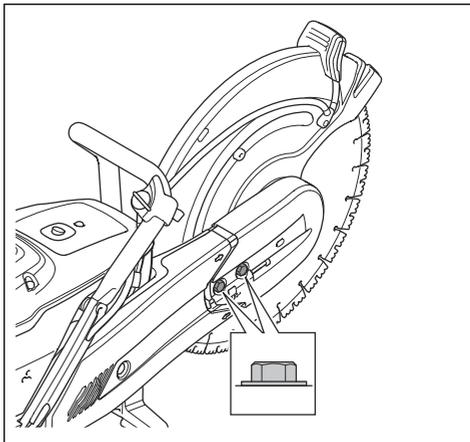
2. 調整ナット (B) がドライブベルトカバーのマークの反対側にくるまで、調整ネジ (A) を回します。
