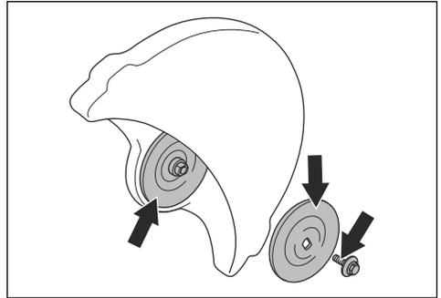
2. 确保切割锯片和凸缘垫片上的接触区域未损坏。更换损坏的部件。
