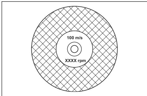
**注記：**この製品に取り付け可能なカッティングブレードの多くは、据え付けソー用です。これらのカッティングブレードの定格速度の値は、本製品には遅すぎます。
