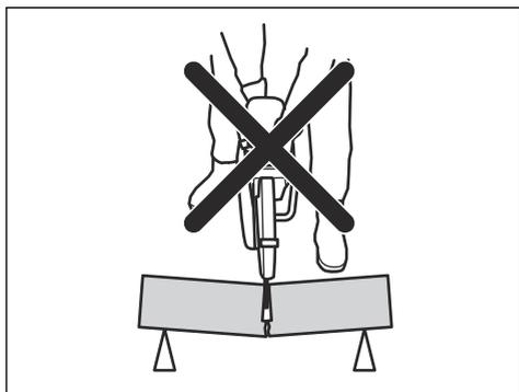
ブレードのキックバックゾーンが挟まったり、引っかかると、反作用力により、作業者に向かってパワーカッターが回転しながら飛ばされて、人命にかかわるような事故が発生することがあります。作業対象物が動く可能性があるので、注意してください。作業対象物がしっかりと保持されておらず、切断時に動くと、ブレードが挟まり、キックバックの原因になる可能性があります。
