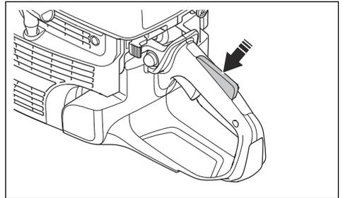
3. 确保油门扳机和油门扳机锁活动自如，且复位弹簧操作正常。
