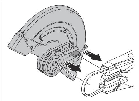
9. 安装切割头和驱动皮带保护罩，请参阅 [更换驱动皮带在第 143 页上](#)。
