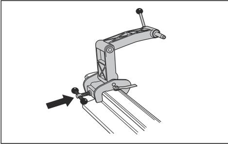
2. 将产品安装到钢轨夹持器上，使产品右侧紧靠在钢轨夹持器上。
