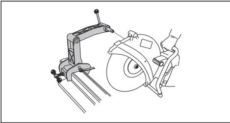
**注意：** 也可以在安装产品时，使左侧紧靠在钢轨夹持器上，但我们建议尽可能使用右侧。
