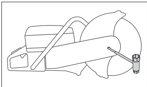
4. Cuttingブレードボルトを 30 Nm / 18.5 ft-lb で締め込みます。
