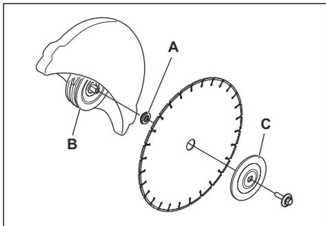
3. 工具をCuttingヘッドの穴へ入れ、シャフトがロックされるまでCuttingブレードを回転させます。
