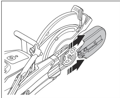
5. ベルトプーリーから駆動ベルトを取り外し、カッティングヘッドを取り外します。
