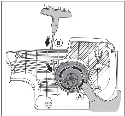
7. 完全拉出启动绳，以检查复位弹簧是否处于其末端位置。确保在复位弹簧停止移动之前，启动器滑轮可以转动半圈或更多圈。
