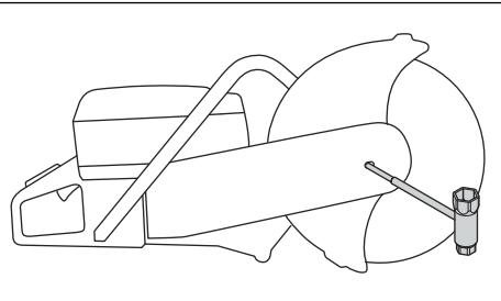
4. اربط مسمار شفرة القطع بقوة 30 نانومتر/18.5 قدم-رطل.
