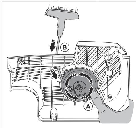
7. スターターロープを完全に引き出し、リコイルスプリングが末端位置にないことを確認します。リコイルスプリングが停止する前に、スタータープーリーが半回転以上回ることを確認してください。
