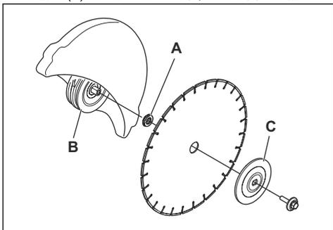
3. 将工具放入切割头的孔内，并转动切割锯片，直至轴锁定。
