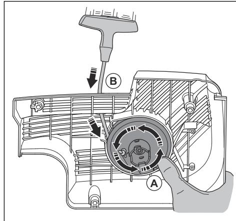
7. スターターロープを完全に引き出し、リコイルスプリングが末端位置にないことを確認します。リコイルスプリングが停止する前に、スターターブーリーが半回転以上回ることを確認してください。
