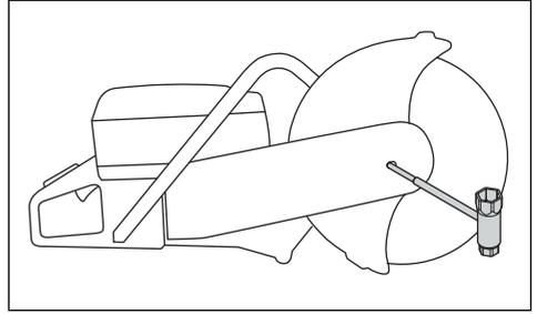
2. 拧松 2 颗螺栓 (A)，然后拧松调节螺丝 (B)，以释放皮带张力。
