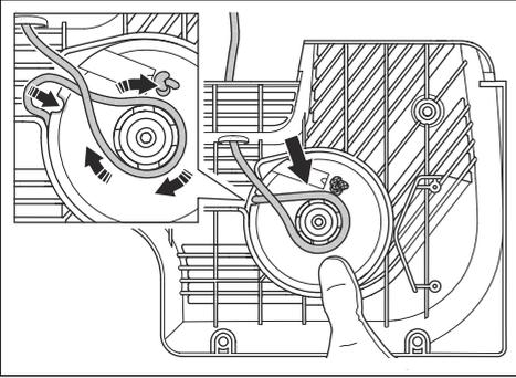
5. 让启动器滑轮缓慢旋转，启动绳缠绕在金属套筒上。
