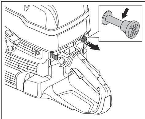
4. 推动风门拉杆以禁用风门。启动油门将保持在位。
