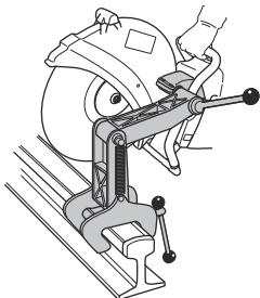
d) 将切割锯片紧靠在钢轨上，并确保其位于切口中心。如有必要，调整夹持器安装衬套。
