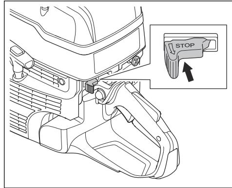
3. 将风门拉杆拉到底，以获得启动油门位置。
