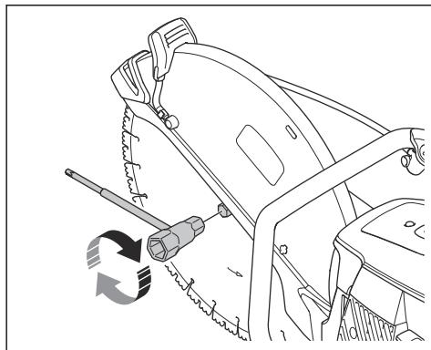
本製品にはリバーシブルのカッティングヘッドが装備されており、壁の近くや地面の高さで切断できます。標準の手順が不可能な場合は、カッティングヘッドを反転させて切断してください。キックバックが発生した場合、カッティングヘッドが反転していると本製品の制御が困難になります。カッティングブレードと本製品の中心間の距離が長いため、ハンドルとカッティングブレードの位置が合っていません。これは、本製品のバランスに悪影響を与え、カッティングブレードがキックバックジーンで挟まったり、引っかかったりした場合に、本製品を保持するのがより困難になります。チック/バック 54 ページを参照してください。
