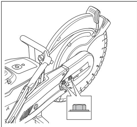
2. 转动调节螺丝 (A)，直到调节螺母 (B) 与驱动皮带保护盖上的标记相对立。
