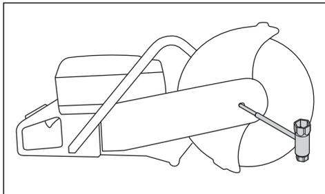
4. 将切割锯片螺栓上紧至 30 牛米/18.5 英尺磅。
