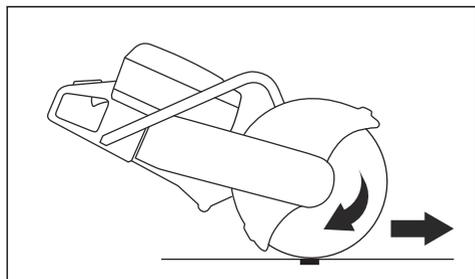
カッティング装置を回転させたまま、本製品を移動しないでください。ジャイロ力により、意図した動きが阻害される場合があります。
