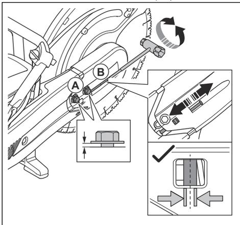
3. コンビレンチを使用して、カッティングヘッドをカッティングアームに固定している 2 本のボルトを締めます。
