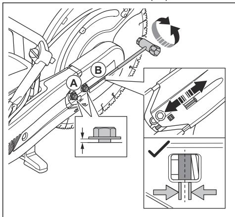
3. コンビレンチを使用して、カッティングヘッドをカッティングアームに固定している 2 本のボルトを締めます。
