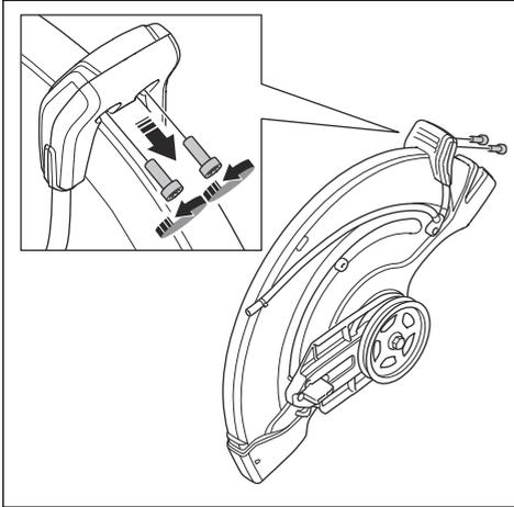
4. ブレードガードの調整ハンドルを取り外します。
