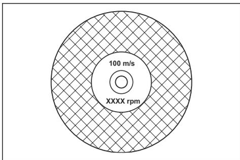
**注記：**この製品に取り付け可能なカッティングブレードの多くは、据え付け専用です。これらのカッティングブレードの定格速度の値は、本製品には遅すぎます。
