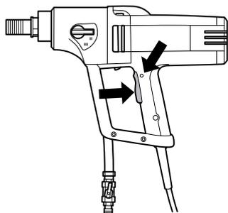
Следит за тем, чтобы выключатель и фиксатор выключателя перемещались свободно.
