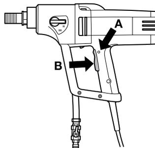
Фиксатор выключателя остается прижатым, пока выключатель находится в нажатом положении. Когда захват ручки освобождается, то и выключатель, и фиксатор выключателя возвращаются в исходное положение. Это происходит под воздействием двух независимых друг от друга систем возвратных пружин. В этом положении машина будет остановлена и выключатель будет замкнут.
