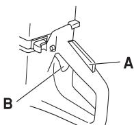
Η ασφάλεια γκαζιού παραμένει πατημένη όσο διάστημα πατιέται και το γκάζι. Οταν αφήσουμε ελεύθερη τη χειρολαβή, επανέρχονται και το γκάζι και η ασφάλεια γκαζιού. Αυτό ρυθμίζεται από δύο μεταξύ τους ανεξάρτητα συστήματα ελατηρίων επαναφοράς. Αυτή η θέση επιφέρει σταμάτημα του μηχανήματος και κλείδωμα του γκαζιού
