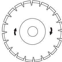
Χρησιμοποιείτε πάντοτε ακονισμένο διαμαντέ δίσκο. Ακονίστε τη λεπίδα πριονίζοντας σε μαλακό υλικό όπως αμμόπετρα ή τούβλο.
