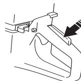
Проверьте, чтобы пускатель и фиксатор пускателя ходили легко и чтобы их пружинная возвратная система функционировала.
