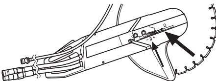
Затяните обе гайки, которыми закреплен режущий рычаг.
