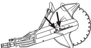
Открутите затем гайки и снимите передний колпак ремня.
