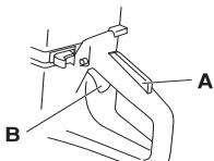
Фиксатор пускателя остается в прижатом внутрь положении до тех пор пока пускатель находится в прижатом внутрь положении. При отпускании ручки, пускатель и фиксатор пускателя возвращаются в свои исходные положения. Это осуществляется при помощи двух независимых одна от другой пружинных возвратных систем. В таком положении станок останавливается и пускатель замыкается.
