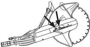
Навинтите затем регулировочный винт так, чтобы четырехгранный гайка находилась посередине отметки на колпаке. Натяжение ремня будет тогда автоматически правильным.
