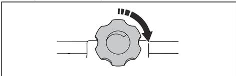
2. Para reduzir o ângulo da lâmina, rode o manípulo de ajuste da lâmina para a esquerda.
