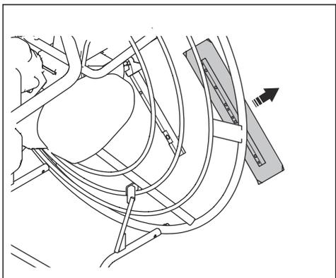
a) Se a lâmina apresentar desgaste apenas numa extremidade, rode a lâmina 180 graus e volte a colocá-la.
