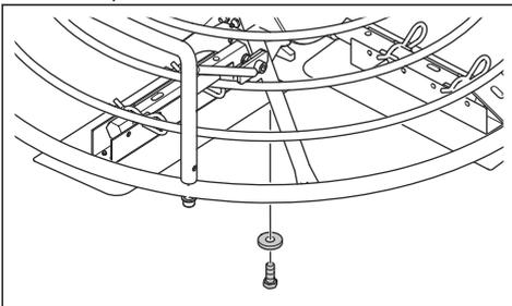
2. Retire o conjunto da lâmina. Utilize um extrator se o conjunto da lâmina não for fácil de remover.
