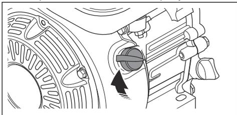
5. Segure o punho do produto com uma mão e puxe lentamente o punho do cabo de arranque até sentir resistência.
