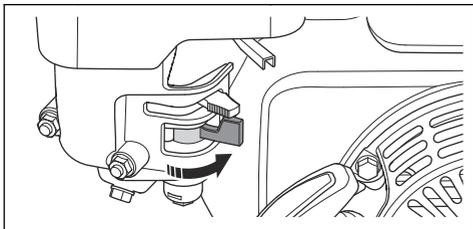
2. Coloque o acelerador na posição de ralenti.
