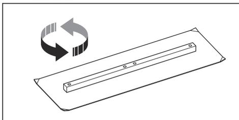
b) Se a lâmina apresentar desgaste nas extremidades dianteira e traseira, substitua-a por uma lâmina nova.
