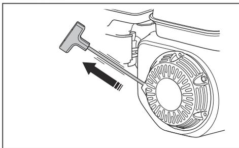
6. Solte o punho do cabo de arranque para deixar o cabo de arranque recolher.
