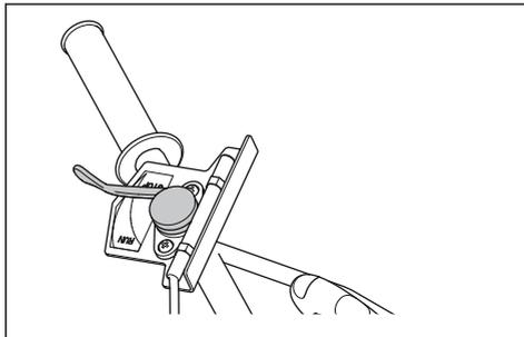
3. Coloque o interruptor LIG/DESL na posição "DESL".
