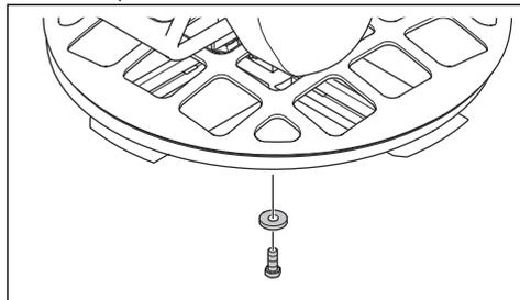
2. Retire o conjunto da lâmina. Utilize um extrator se o conjunto da lâmina não for fácil de remover.
