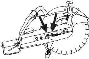
Dann die Stellschraube so drehen, dass sich die Vierkantmutter vor der Markierung am Gehäuse befindet. Der Riemen erhält so automatisch die korrekte Spannung.
