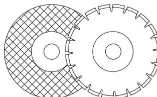
Bei Transporten des Geräts immer die Trennscheibe demontieren. Darauf achten, dass für die Trennscheibe jeweils die richtige Buchse montiert wird. Siehe die Anweisungen unter der Überschrift Montage der Trennscheibe.
