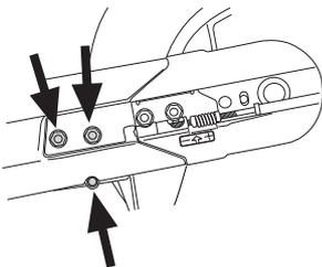
Den alten Riemen entfernen und den neuen Riemen montieren. Trennarm und Motorteil zusammenfügen und den Riemen mit der Stellschraube spannen. Ein neuer Antriebsriemen ist nach ca. 30 min Betrieb nachzuspannen.
