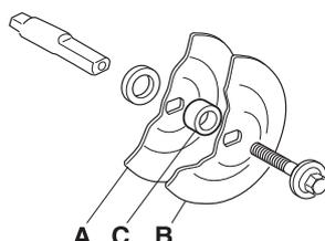
Die Schraube, die die Trennscheibe hält, mit einem Anziehmoment von 15-25 Nm anziehen.
