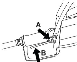
Der Schutzschalter bleibt gedrückt, solange der Einschalter gedrückt ist. Wird der Griff gelockert, werden sowohl Einschalter als auch Schutzschalter zurückgesetzt. Dies geschieht durch zwei voneinander unabhängige Rückzugfedersysteme. In dieser Position stoppt die Maschine und der Einschalter wird gesperrt.
