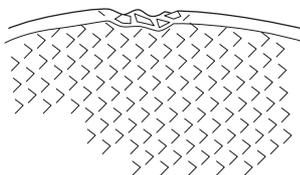
Die Abrasivscheibe prüfen, indem man sie auf einen Finger hängt und mit einem Schraubenziehergriff o. Ä. leicht dagegen schlägt. Gibt die Scheibe keinen vollen, klingenden Ton von sich, ist sie beschädigt.
