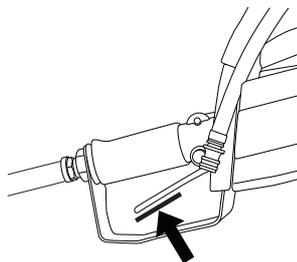
Schutzschalter drücken und prüfen, dass er beim Loslassen in seine Ausgangsposition zurückgeht.
