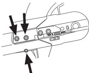
Saque la correa vieja y monte la correa nueva. Arme el brazo de corte con la sección de motor y tense la correa con el tornillo de ajuste. Una correa nueva se debe reajustar después de aproximadamente 30 minutos de funcionamiento.
