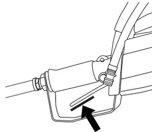
Presione el bloqueador de acelerador y controle que retorna a su posición inicial al soltarlo.
