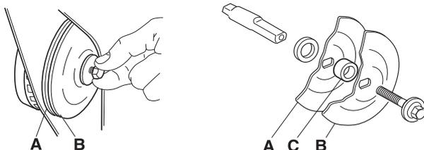
El tornillo que sostiene el disco de corte debe apretarse con un par de 15-25 Nm.
