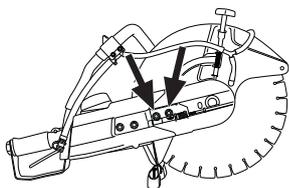
Seguidamente, enrosque el tornillo de ajuste para que la tuerca rectangular quede frente a la marca del envoltente. Así, la correa recibe automáticamente el tensado correcto.
