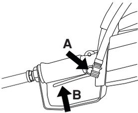
El bloqueador de acelerador permanece en posición interior mientras está presionado el acelerador. Cuando se suelta la empuñadura, el acelerador y el bloqueador de acelerador retornan a la posición inicial. Esto se hace con dos sistemas de muelles de retorno independientes. En esta posición la máquina se para y el acelerador es bloqueado.
