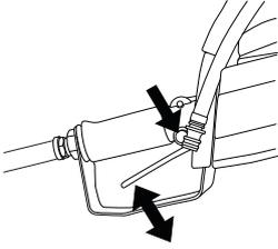
Arranque la máquina, suelte el acelerador y controle que el motor y el disco de corte se paran.
