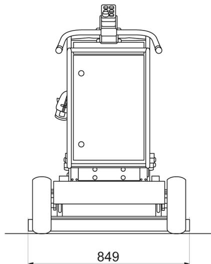
Figure 8-2. Cotes de largeur en mm
