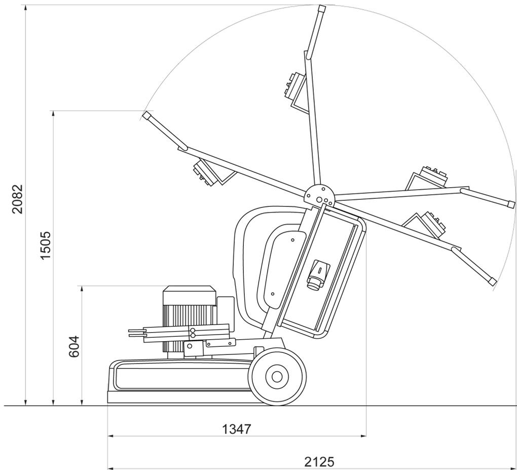
Figure 8-1. Cotes de hauteur et de longueur en mm
