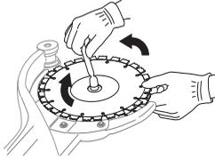
**ATTENTION !** Il est très important que les lames tournent quand l'écrou est serré. Ceci indique que la courroie n'est pas coincée entre les demi-poulies intégrées des lames quand les lames/les poulies sont serrées avec l'écrou. Effectuer le serrage en alternance, c.-à-d. serrer un peu, faire pivoter et continuer ainsi jusqu'à ce que les lames soient bien attachées.
