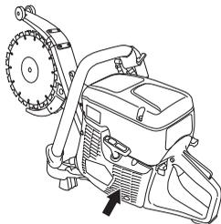
**ATTENTION !** Une prise d'air sale ou bouchée provoque la surchauffe de la machine, ce qui endommage le piston et le cylindre.
