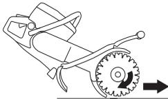
Ne pas déplacer la machine quand l'équipement de coupe tourne. Les forces gyroscopiques peuvent entraver le mouvement prévu.
