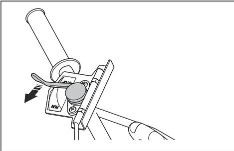
11. Schieben Sie die Kupplungssteuerung auf der linken Seite gegen den Griff. Halten Sie die Kupplungssteuerung während des Betriebs in dieser Position.
