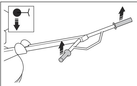
2. Drehen Sie den Regler für die Glättflügeleinstellung gegen den Uhrzeigersinn, um den Winkel der Glättflügel zu verkleinern.
