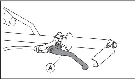
**Hinweis:** Die Abbildung zeigt die Kupplungssteuerung an den Modellen BG 245 und BG 375 (H5-BC). Die Modelle BG 475 und BG 375 (H6-BC, H9-BC) haben eine längere Kupplungssteuerung, aber die Funktion ist die gleiche. Siehe *Produktübersicht (BG 375, BG 475) auf Seite 3* und *So starten Sie das Gerät auf Seite 10*.
