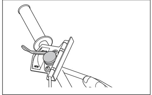
3. Stellen Sie den ON/OFF-Schalter für den Motor auf „OFF“ (Aus). Der Motor wird angehalten.
