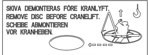
Entfernen Sie die Schwimmscheibe, bevor Sie das Gerät anheben.
