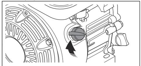
5. Halten Sie den Griff am Gerät mit einer Hand und ziehen Sie den Startseilhandgriff langsam, bis Sie einen Widerstand spüren.
