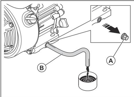
3. Neigen Sie das Gerät und lassen Sie das Öl in den Behälter laufen.
