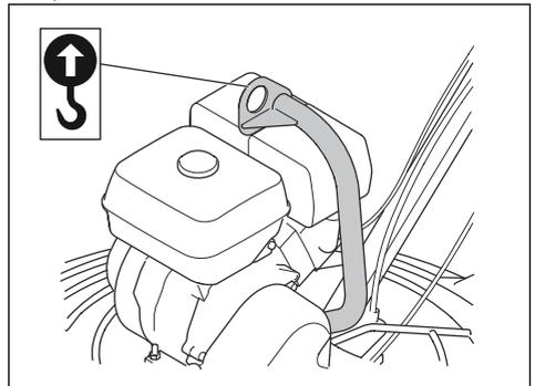
Der Bediengriff und der Stützrahmen für die Wartungsposition sind starke Strukturen, die Sie beim Bewegen eines angehobenen Geräts halten können.
