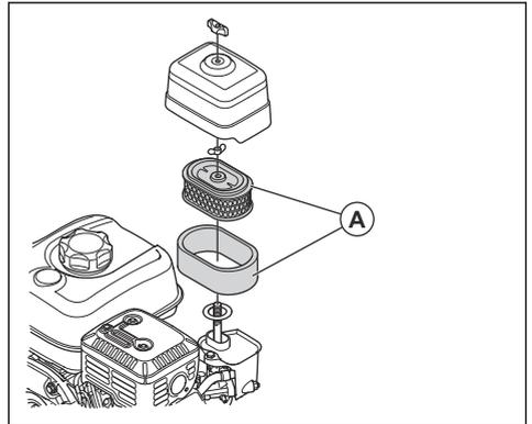
3. Reinigen Sie das Luftfiltergehäuse mit einer Bürste.
