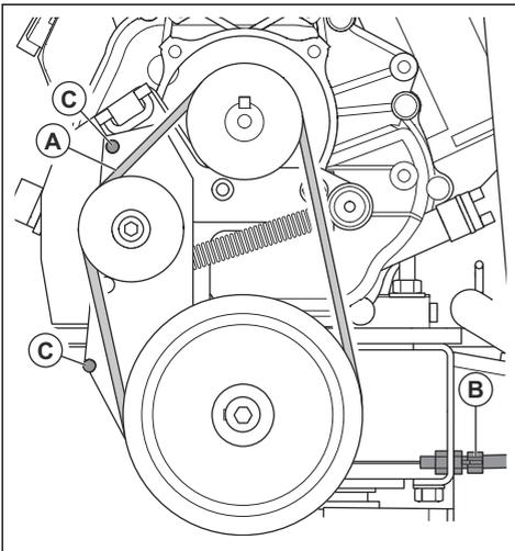
4. Überprüfen Sie die Spannung des Keilriemens.
