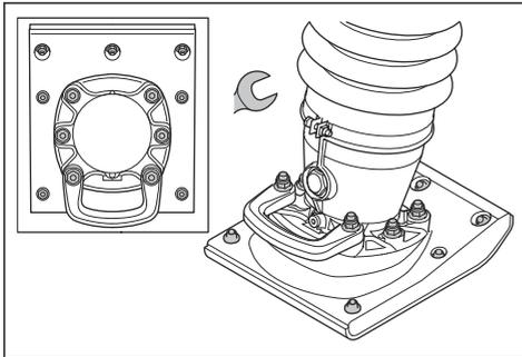
**注意：**280 mm/11 in. 宽的冲击夯底板有 13 颗螺栓。330 mm/13 in. 宽的冲击夯底板有 19 颗螺栓。
