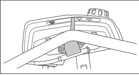
2. 将油门控制设在停止位置。
