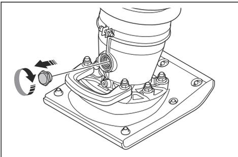
6. 通过观察孔的孔加注新油。有关正确的油类型，请参阅 *技术参数* 在第 12 页上。
