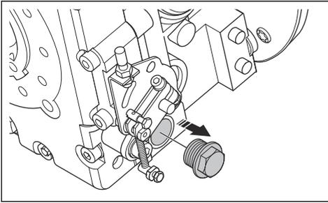
3. 将软管连接到排油孔。
