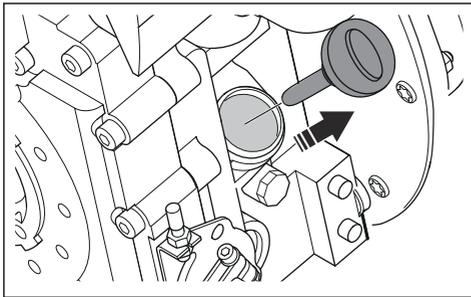
4. Coloque a vareta de volta totalmente no tanque de óleo.
