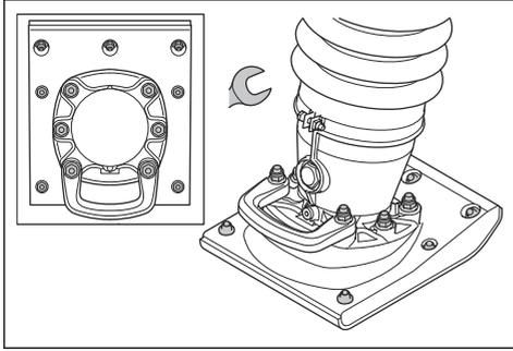
**Observação:** Uma sapata do compactador de 280 mm/11 pol. de largura tem 13 parafusos. Uma sapata do compactador de 330 mm/13 pol. de largura tem 19 parafusos.
