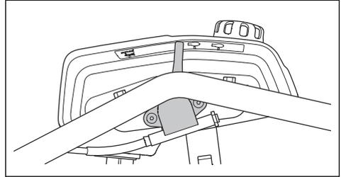
2. Coloque o acelerador na posição de paragem.
