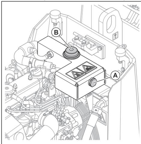
3. Se il livello del liquido di raffreddamento del radiatore è troppo basso, rimuovere il tappo del radiatore (B). Riempire con liquido di raffreddamento del radiatore fino a quando il livello non è corretto.
