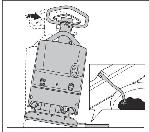
**Remarque:** il est également possible d'utiliser une pompe manuelle de vidange d'huile pour vidanger l'huile de l'élément excentrique.
