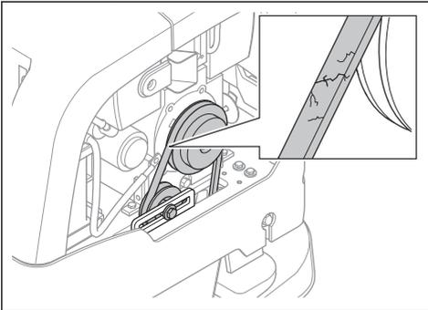
4. Contrôlez la tension de la courroie trapézoïdale.
