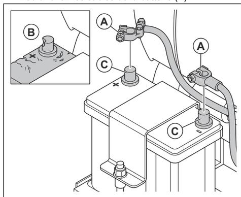
2. Vérifiez l'absence de dommages sur la batterie (B). Remplacez la batterie si elle est endommagée.
