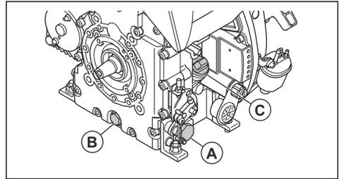
2. Déposez le bouchon de vidange d'huile (A) ou (B) et branchez un flexible.
