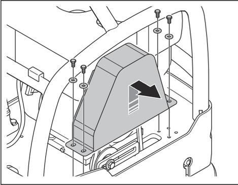
3. Vérifiez l'absence de dommages et de défauts au niveau de la courroie trapézoïdale. Remplacez la courroie trapézoïdale si nécessaire.
