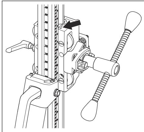
3. 从顶部滚轮轴开始操作。使用平头螺丝起子顺时针旋转以使滚轮轴靠近钻柱。
