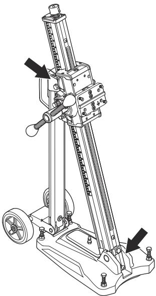
2. 角度インジケータを使用して、およその調整を行います。より高い精度が必要な場合は、別の方法で測定してください。
