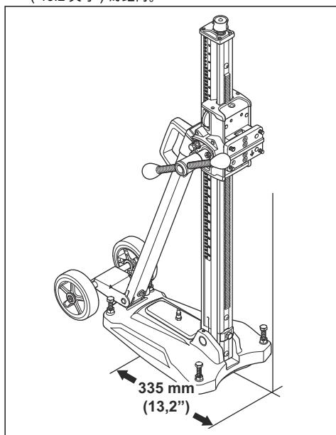
2. 使用膨胀螺丝安装底板。
