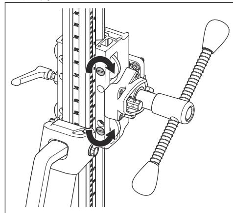
6. 位置決めネジを締めつけて、ローラーシャフトを固定します。
