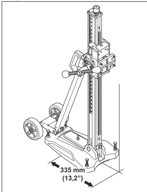
2. エキスパンダボルトを使用してボトムプレートを取り付けます。
