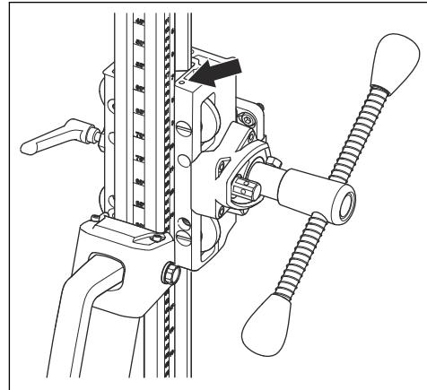
3. 上部ローラーシャフトから作業を開始します。マイナスドライバーで時計方向に回し、ローラーシャフトをドリルコラムに近づけます。
