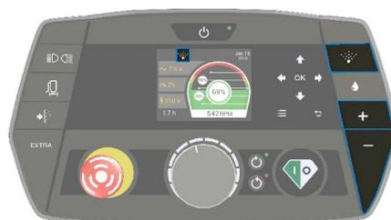
Disattivare Mist Cooler System premendo il pulsante Mist Cooler System sul quadro di controllo. Vedere Quadro di controllo (HMI) pagina 22 pos 8.
