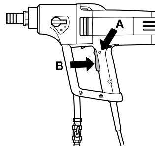
Prekidač za zaključavanje paljenja ostaje pritisnut sve dok je prekidač za paljenje pritisnut. Ako je držać na ručici pušten, i prekidač za paljenje i prekidač za zaključavanje paljenja se vraćaju u početni položaj. Pomeranje kontrolišu dve zasebne povratne opruge. Ovaj položaj dovodi do prestanka rada mašine i zaključavanja prekidača za paljenje.
