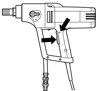
Proverite da li se prekidač napajanja i blokada prekidača napajanja lako pomiču.
