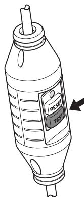
Prekidač u slučaju otkaza uzemljenja će se aktivirati i mašina će se odmah isključiti. U suprotnom, obratite se svom prodavcu.
