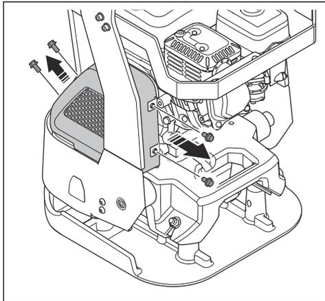
3. Controllare se la cinghia trapezoidale presenta danni e usura. Sostituire la cinghia trapezoidale se danneggiata o usurata.
