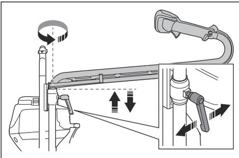
3. Ziehen Sie die Verriegelungshebel fest, wenn die korrekte Betriebsposition eingestellt ist.
