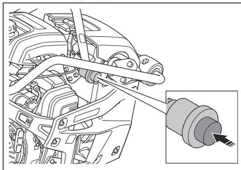
10. 向下折叠空气滤清器罩，然后使橡胶门锁回到空气滤清器罩的锁定位置。
