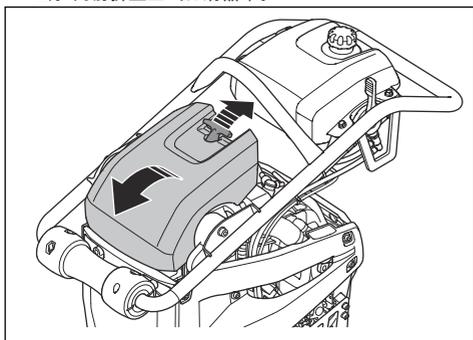
3. 从空气滤清器室中拆下空气滤清器。
