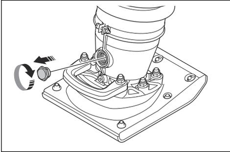
6. 通过观察孔的孔加注新油。有关正确的油类型，请参阅技术参数在第 15 页上。
