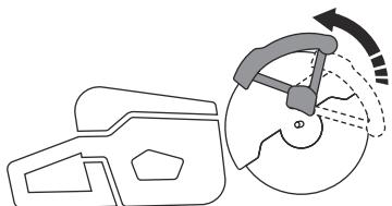
5. Apriete el perno del disco de corte a 25 Nm (18,5 ft-lb).
