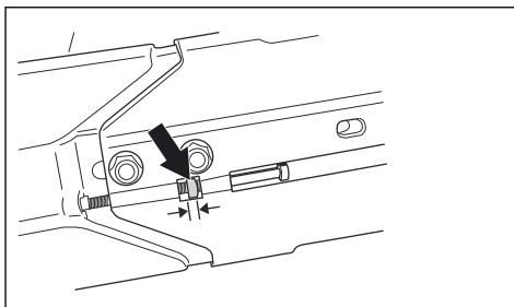
Serrare una nuova cinghia di trasmissione dopo 1 ora di funzionamento.
