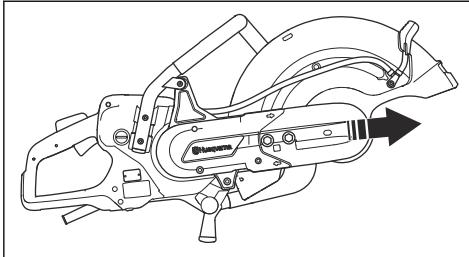
4. Desligue o bocal da mangueira de água, a mangueira de água e o punho da proteção da lâmina. Retire o batente.
