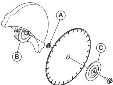
4. Introduza uma ferramenta no orifício da proteção da correia dianteira e rode a lâmina de corte até o eixo se encontrar fixo.
