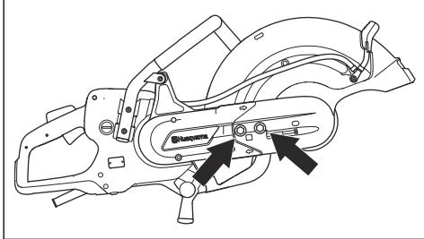
2. Ruotare le viti di regolazione finché il dado di regolazione non si trova di fronte al contrassegno sul coperchio della cinghia di trasmissione.
