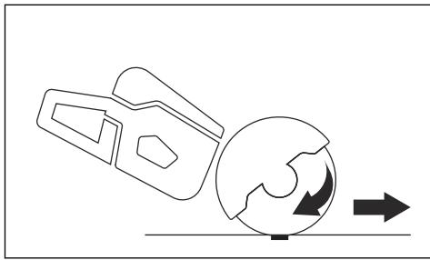
No mueva el producto mientras el equipo de corte está girando. Las fuerzas giroscópicas pueden obstaculizar el movimiento deseado
