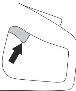
5. Solte o interruptor de alimentação e certifique-se de que a lâmina de corte para em menos de 10 segundos e permanece parada.
