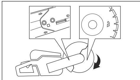
2. Individuare la freccia sul disco di taglio che mostra il senso di rotazione del disco di taglio.
