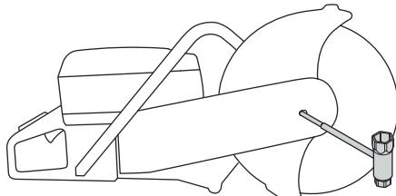
5. Aperte o parafuso da lâmina de corte com um binário de 25 Nm/18,5 lb-pés.
