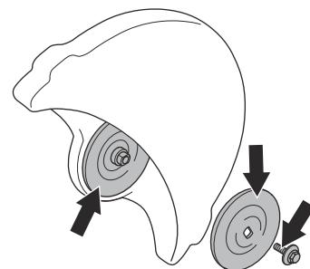
2. Assicurarsi che le zone di contatto sul disco di taglio e sulle rondelle flangiate non siano danneggiate. Sostituire le parti danneggiate.
