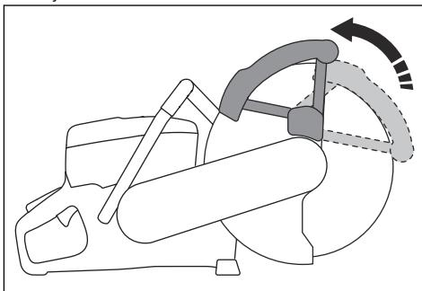
3. Limpe ou substitua o SmartGuard se este não regressar à posição imediatamente após ser pressionado, ou se estiver danificado.
