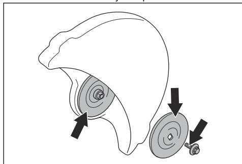
2. Asegúrese de que las áreas de contacto del disco de corte y las arandelas de brida no están dañadas. Sustituya las piezas dañadas.
