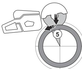
**ATENÇÃO:** Se o tubo estiver devidamente apoiado, não deve fazer com que a lâmina fique presa quando separado na secção 5. No entanto, tenha o cuidado de verificar se a lâmina fica presa durante a separação final. Se a lâmina ficar presa na secção inferior, o produto pode ser puxado para a frente, afastando-se do operador em vez de se verificar um retrocesso rotativo.
