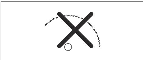
El uso de esta cortadora con un disco con punta de carburo es contrario a las normas de seguridad en el trabajo.
