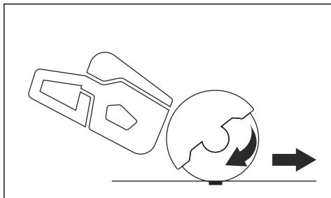
Nunca move o produto aquando da rotação do equipamento de corte. A força giroscópica pode obstruir o movimento pretendido
