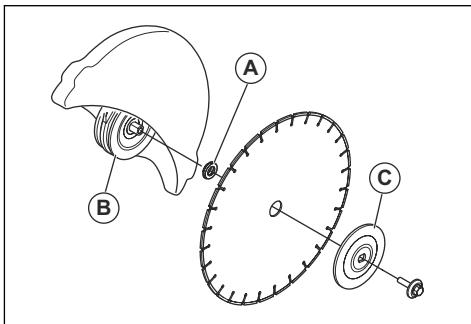
4. Inserire un attrezzo nel foro del carter della cinghia anteriore e far ruotare il disco di taglio finché l'asta non si blocca.
