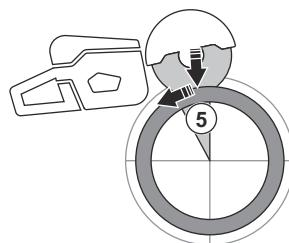
**AVVERTENZA:** Se il tubo è sostenuto correttamente, non dovrebbe inceppare il disco quando viene separato nella sezione 5. Tuttavia, prestare attenzione se il disco si inceppa durante la separazione finale. Se il disco si inceppa nella sezione inferiore, il prodotto potrebbe allontanarsi dall'operatore, anziché causare un contraccolpo rotante.
