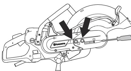
3. Remova os parafusos e solte a proteção da correia.
