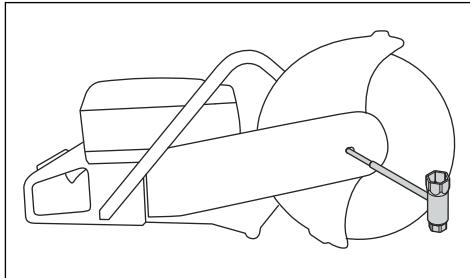
2. Afloje los 2 pernos y, a continuación, el tornillo de ajuste para destensar la correa.
