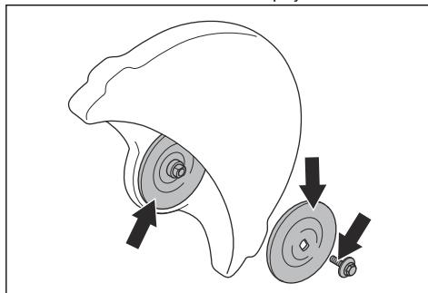
2. Certifique-se de que as áreas de contacto no disco de corte e nas anilhas flangeadas não estão danificadas. Substitua as peças danificadas.
