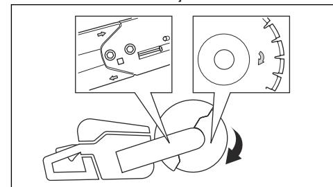
2. Procure a seta na lâmina de corte que indica o sentido de rotação da lâmina de corte.
