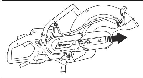
4. Desconecte la boquilla de la manguera de agua, la manguera de agua y la empuñadura de la protección del disco. Retire el tope.
