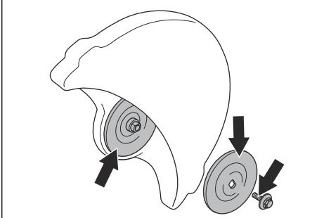
2. Βεβαιωθείτε ότι οι περιοχές επαφής στη λεπίδα κοπής και στις ροδέλες φλάντζας δεν έχουν υποστεί ζημιά. Αντικαταστήστε τα μέρη που έχουν υποστεί βλάβη.
