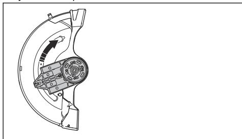
7. Fije el cabezal de corte en el otro lado del producto.
