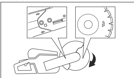
2. Observe la flecha del disco de corte que indica el sentido de rotación del disco de corte.
