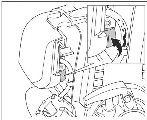
4. Tirare l'impugnatura del cavo di avviamento finché il motore non si avvia.
