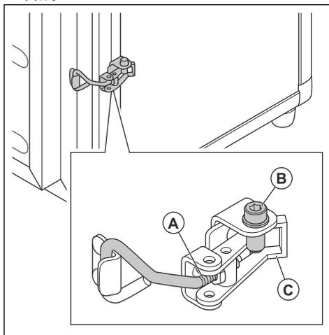
5. 将所有肘节紧固件推到锁定位置 (C)。
