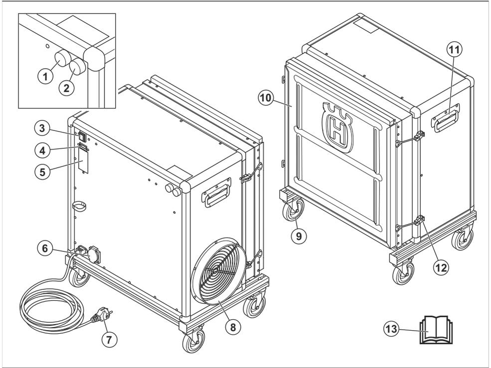
1. 过滤器系统受损或安装不正确的指示灯
