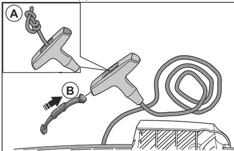
14. Fissare il coperchio sull'impugnatura della fune di avviamento (B).
