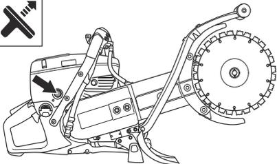
4. Spingere il comando della valvola dell'aria per disattivare il comando dell'aria. L'acceleratore di avviamento si trova in posizione.
