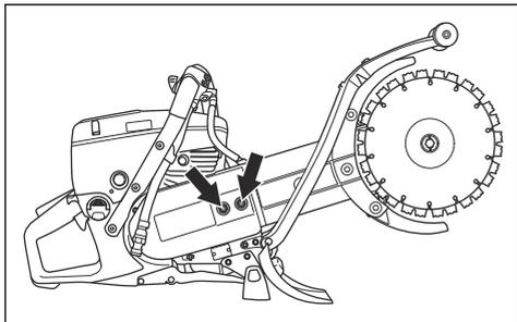
2. Ruotare il tendicinghia in senso orario e controllare con 1 dito la regolazione della cinghia di trasmissione.
