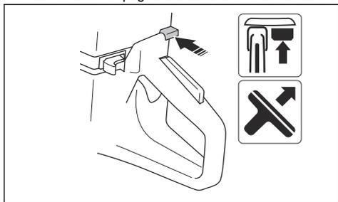
9. Premere il grilletto acceleratore per disinserire l'acceleratore di avviamento e il prodotto girerà al minimo.
