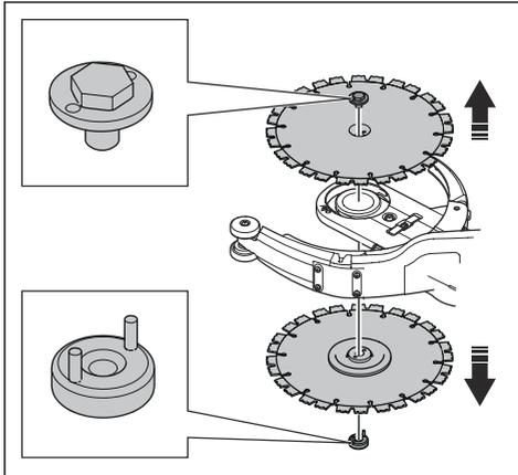
4. Posizionare i nuovi dischi su ciascun lato della barra. Inserire i perni del dado attraverso i dischi e la rondella del bullone.
