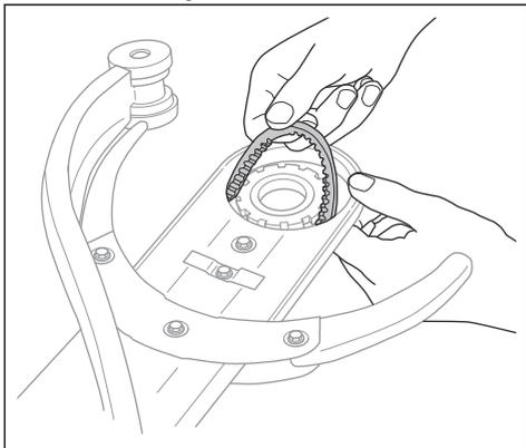
5. Allentare il tubo dell'acqua (A). Spostare la barra all'indietro e rimuovere la cinghia di trasmissione.
