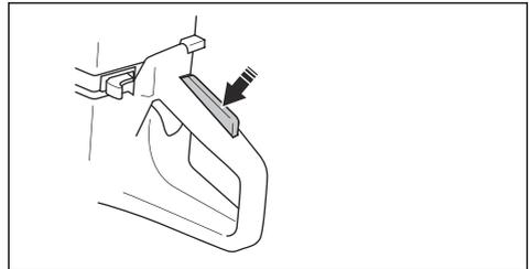
3. Controllare che il grilletto acceleratore e il relativo blocco si muovano liberamente e che le molle di richiamo funzionino correttamente.
