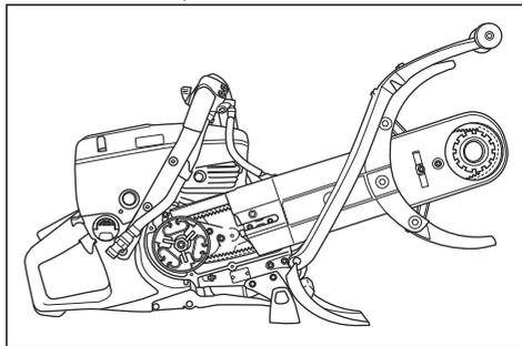
4. Sfilare la cinghia di trasmissione dalla parte anteriore del braccio di taglio.
