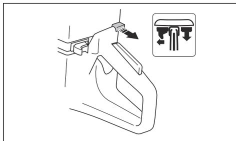
3. Spingere la valvola di decompressione per diminuire la pressione nel cilindro. Una volta avviato il prodotto, la valvola di decompressione ritorna automaticamente nella posizione iniziale.
