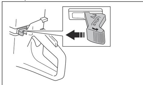
2. Tirare il comando della valvola dell'aria completamente e portarlo in posizione di avviamento.
