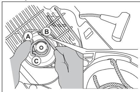
3. Posizionare la fune di avviamento nell'incavo (B) della puleggia di avviamento.
