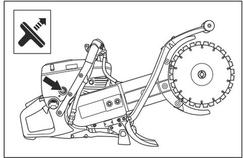
4. Premere 6 volte sul primer finché non si riempie completamente di carburante.
