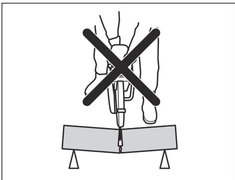
Se il disco è schiacciato o bloccato nel settore di contraccolpo, la forza di reazione respingerà la troncatrice in senso rotatorio in alto e indietro verso l'utente causando lesioni gravi o mortali. Fare attenzione al possibile spostamento del pezzo in lavorazione. Se esso non è adeguatamente supportato e si sposta durante il taglio, potrebbe schiacciare la lama e causare un contraccolpo.
