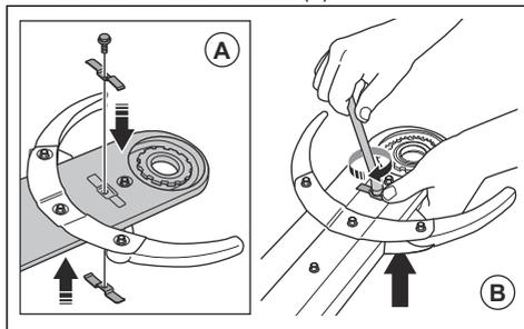
12. Installare le lame. Fare riferimento a *Sostituzione dei dischi di taglio alla pagina 20*.
