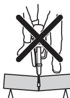
Ako se nož zaglavi ili zaustavi u zoni povratnog trzaja, motorni čistač će se usled reaktivne sile odbaciti i okrenuti unazad prema korisniku što dovodi do ozbiljnih ili čak fatalnih povreda. Pazite na moguće pokrete komada koji obrađujete. Ako komad koji obrađujete nije pravilno pričvršćen i pomeri se tokom sečenja, on može uštinuti sečivo i izazvati povratni trzaj.
