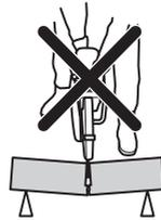
ブレードがキックバックゾーンで挟まったり、引っかかったりすると、反作用力により、作業者に向かってパワーカッターが回転しながら飛ばされて、人命にかかわるような事故が発生することもあります。作業対象物が動く可能性があるので、注意してください。作業対象物がしっかりと保持されておらず、切断時に動くと、ブレードが挟まり、キックバックの原因になる可能性があります。
