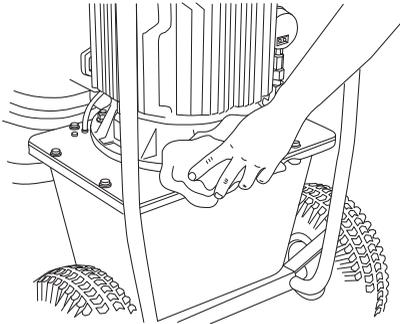
**OBS!** Unngå å rengjøre strømaggregatet med høytrykksspyler. Maskinen må ikke vaskes med vann. Det kan føre til at vann kommer inn i det elektriske systemet eller motoren, og forårsaker skade eller kortslutning.
