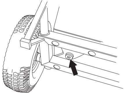
• Skru inn tappepluggen når all væske er tappet ut. Hydraulikkolje fylles på gjennom filteret foran på tanken.
