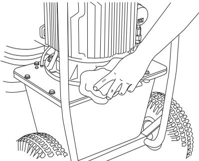
BEMÆRK! Brug ikke en højtryksrens til at rengøre kraftenheden. Vask ikke maskinen med vand, da vand kan trænge ind i det elektriske system eller motoren og forårsage skade på maskinen eller kortslutning.
