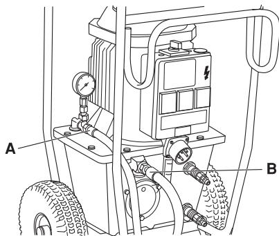
Manguera hidráulica, entrada de retorno (B)
