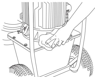
N.B! Non utilizzare una lancia ad alta pressione per pulire l'unità di potenza. Non lavare la macchina con acqua poiché l'acqua può penetrare nel sistema elettrico e causare danni alla macchina o un cortocircuito.
