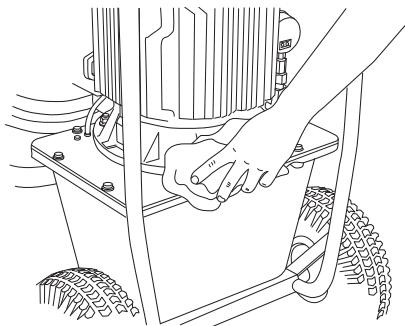
**¡NOTA!** No utilice un equipo de limpieza a alta presión para limpiar la unidad. No lave la máquina con agua, ya que puede penetrar en el sistema eléctrico o en el motor y causar daños en la máquina o un cortocircuito.
