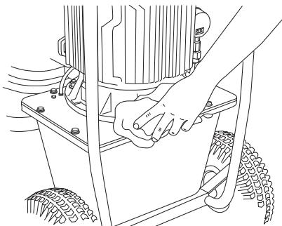
**NOTA!** Não utilize equipamentos de lavagem a alta pressão para limpar a unidade de alimentação. Não lave a máquina com água, pois esta pode penetrar no sistema eléctrico e causar danos ou curto-circuitos.
