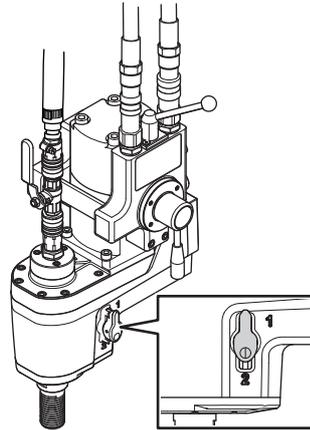
**注意！**機械式ギアの変更は、マシンの電源を切り、停止してから行ってください。停止しないで変更すると、ギアボックスを損傷する危険があります。
