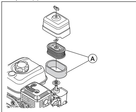
3. Pulire l'alloggiamento del filtro dell'aria con una spazzola.
