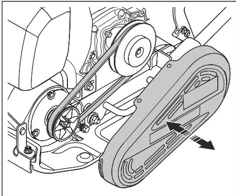
3. Controllare se la cinghia trapezoidale presenta danni e usura. Sostituire la cinghia trapezoidale, se necessario.
