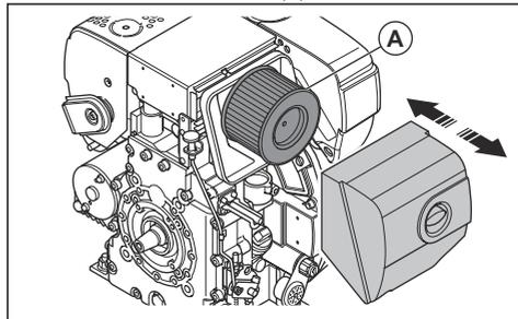
3. Pulire l'alloggiamento del filtro dell'aria con una spazzola.
